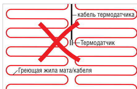
Неверное размещение термодатчика
